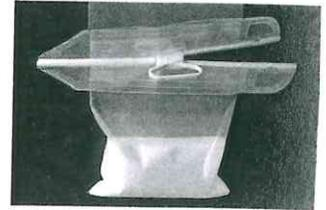
das Gebinde bzw. den Andockadapter an der Prozesseinheit staubdicht verschließt. Das Containment-System ist kompatibel mit allen gängigen Füllsystemen und zeichnet sich durch einfache Handhabung bei maximaler Bediener-sicherheit aus.
